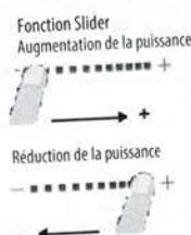
Placez une casserole sur la zone de cuisson, allumez la table de cuisson, puis activez la zone de cuisson requise en appuyant sur la touche « + » correspondante ; « 0 » apparaît à l'écran. Il est possible de sélectionner le niveau de puissance requis, de 0 min. à 9 max., ou le booster « P » si disponible. Pour augmenter le niveau de puissance, appuyez sur la touche « + ». Pour diminuer le niveau de puissance, appuyez sur la touche « - ».
